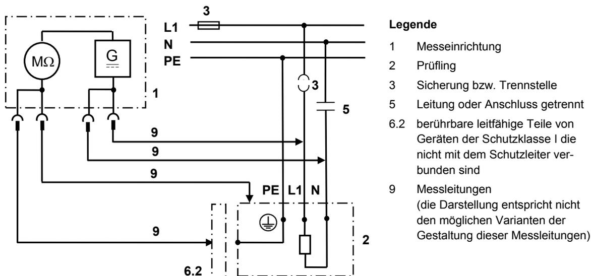
**Beispiel:** Gerät der Schutzklasse I, dessen Verbindungen zum Versorgungsnetz (Klemmen oder Stecker) an der Anschlussstelle nur schwer zu lösen sind, aber an anderer Stelle (Verteiler) gelöst werden können.
